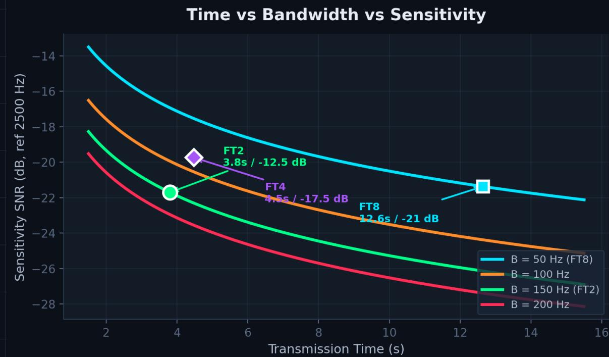
O gráfico mostra a relação entre FT8 e FT2, com 3,8 segundos e largura de banda de 150Hz. (curva verde), a sensibilidade é de aproximadamente -12/-13 dB. A perda comparada com FT8 (-21 dB) é de algo em torno de 8 dB, mas isso compensa em um aumento de 4x na velocidade. Para cenários com sinais fortes como DXpeditions, contests e pile-ups, este cenário é altamente favorável.
